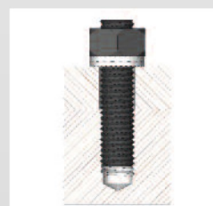
HEICO-LOCK® sécurise l'écrou vissé sur un goujon
