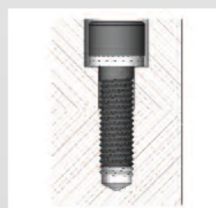
HEICO-LOCK® HLS dans le filetage sécurise une vis CHC
