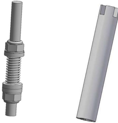
**Bild 3**      Hubventil                      Drehventil
