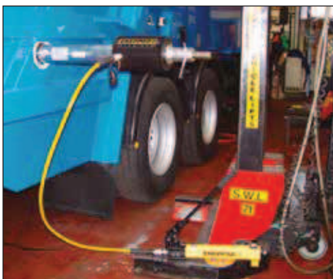
◀ Een RACH-306 verwijderd in combinatie met een P-392 handpomp verroeste bevestigingspennen van vuilniswagens.
