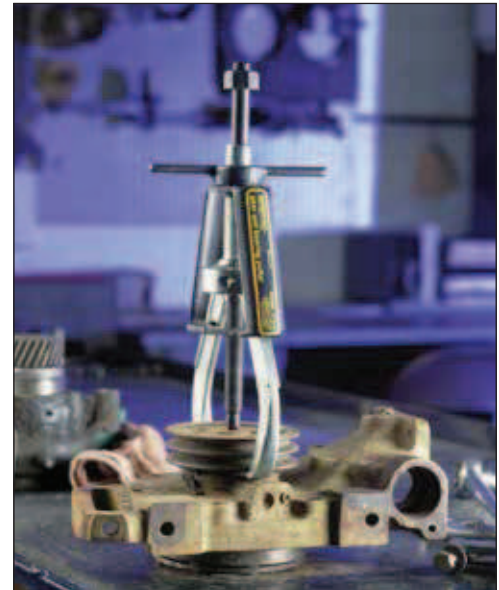
▲ EP-204 met 2 trekarmen, gepositioneerd om de riemschijf van een waterpomp te trekken.
