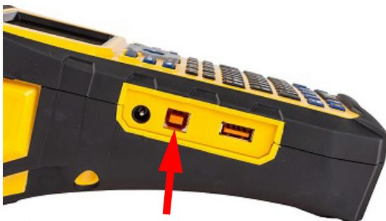
USB-Kabel an diesen Anschluss anschließen
