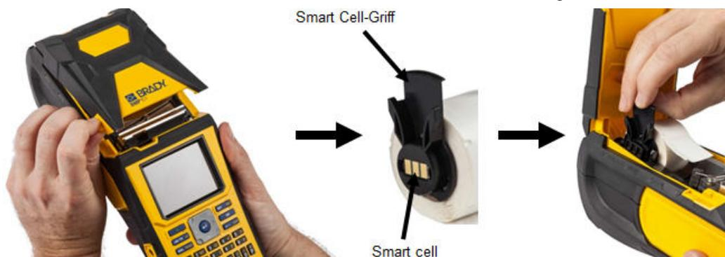
3. Wenn Sie Etikettenmaterialien verwenden, die eine andere Breite als 51 mm (2 Zoll) haben, die Medienführung nach links schieben, bis sie eng an der Etikettenrolle anliegt und einrastet.
