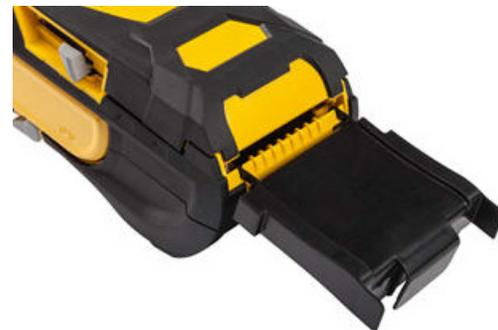
5. Die Etikettenspule des BMP®61 in den Drucker einsetzen (die Smart-Cell zeigt nach links). Die Medienführung nach Bedarf anpassen.
