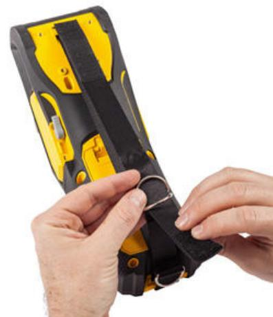
5. Das lose Ende des Gurts zurück über den unteren Ring und dann unter und durch den oberen Ring führen.
