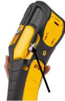
3. Wenn die Etikettenspule nicht leer ist, die Spule vorsichtig mit dem Finger aufwickeln, um die unbenutzten Etiketten rückwärts aus dem Druckkopf herauszuführen.
