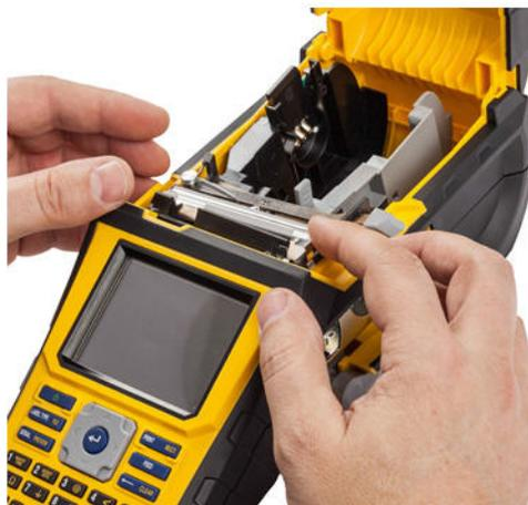
2. Wechseln Sie das Messer oder reinigen Sie es mithilfe eines feuchten Tupfers aus dem Brady-Reinigungsset PCK-6.
