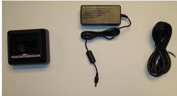
1. Das runde Ende des Adapterkabels in den Steckanschluss auf der Rückseite des Schnellladegeräts einführen.
