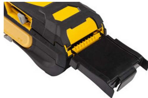
5. Insérez la bobine d'étiquettes BMP®61 (poignée Smart Cell orientée vers la gauche) dans l'imprimante. Réglez le guide de média comme voulu.
