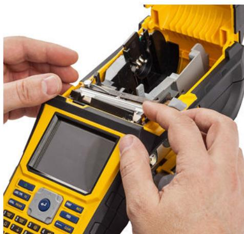
2. Remplacez la lame ou nettoyez-la à l'aide d'un coton-tige pré-imbibé du kit de nettoyage Brady PCK-6.
