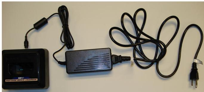
3. Insérez la batterie dans le chargeur avec l'étiquette face à l'avant du chargeur.
