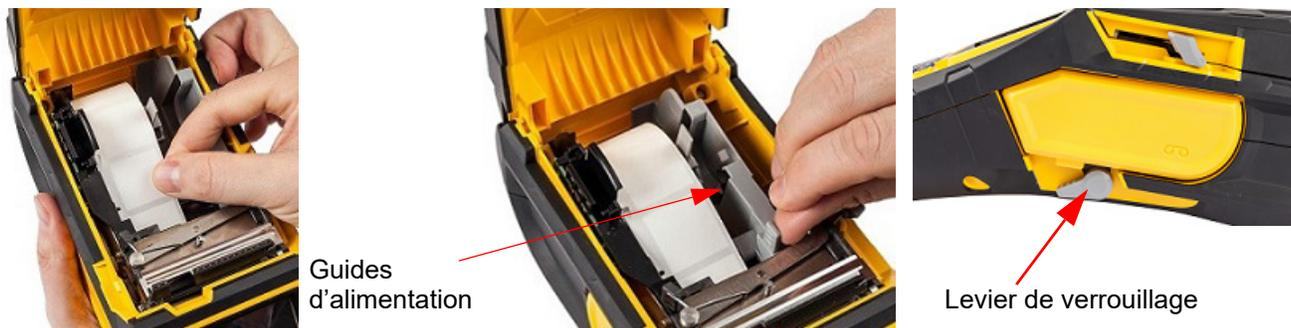
5. Lorsque l'imprimante est sous tension, appuyez une fois sur la touche Feed (Avance) pour insérer le consommable sous la tête d'impression.
