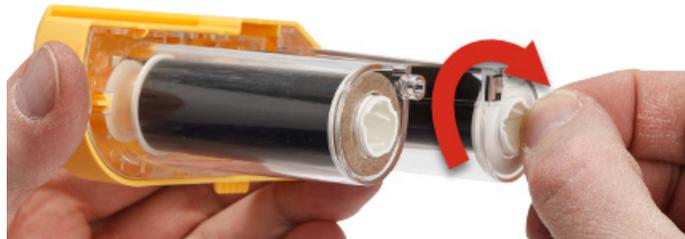
2. Faites doucement glisser le ruban encreur dans l'imprimante jusqu'à ce qu'il repose fermement contre le cadre métallique, puis faites basculer le levier de verrouillage de la tête d'impression vers l'avant (vers la gauche) pour remettre la tête d'impression en place.
