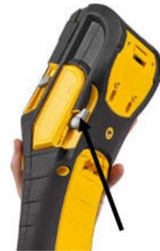
3. Si la bobine d'étiquettes n'est pas vide, enroulez doucement la bobine vers l'arrière avec votre doigt pour faire reculer les étiquettes inutilisées depuis le dessous de la tête d'impression.
