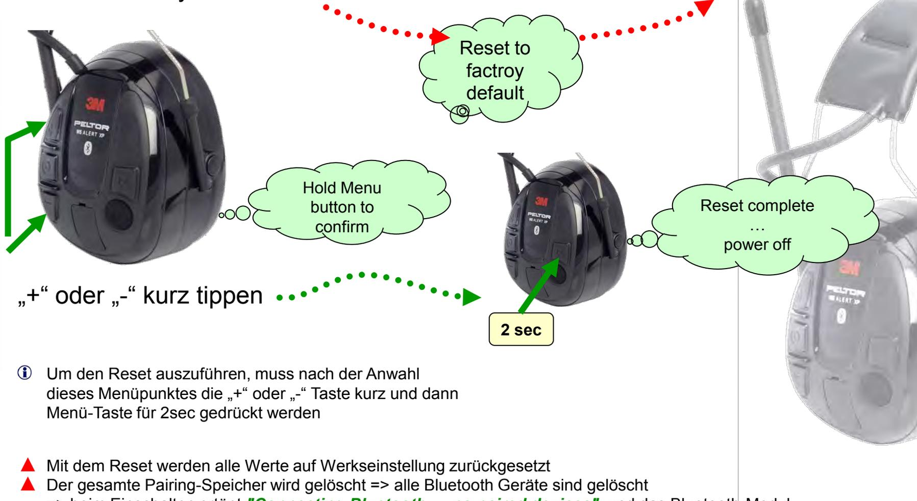
**i** Um den Reset auszuführen, muss nach der Anwahl dieses Menüpunktes die „+“ oder „-“ Taste kurz und dann Menü-Taste für 2sec gedrückt werden
